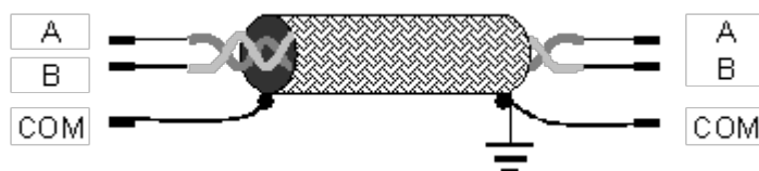
Рис. 2. Схема соединения «витой парой»
